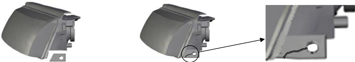
1. Exempel (vänster) på en strålkastare med ett skadat fäste: Fästet är helt avbrutet men tillvarataget (ett nytt fäste behöver inte byggas upp) och kan därför tidsättas enligt reparationsgrupp 2.
